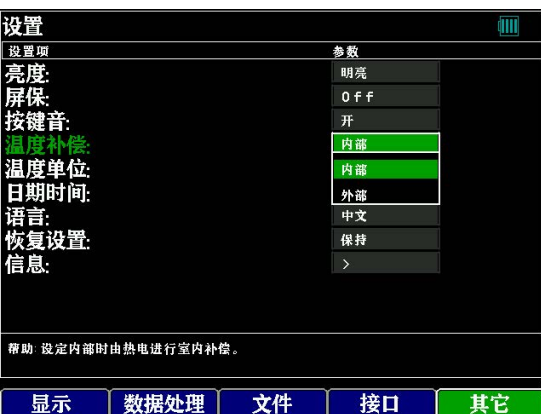
记录仪环境温度补偿方式，内部补偿使用记录仪内部测温探头进行环境温度补偿；外部补偿时请使用第一通道，接上K型热电偶，记录仪会用第一通道测得的温度数据来进行环境温度补偿。
